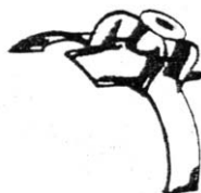
۸- پایه مخصوص نصب روی ساختمان‌های سوله
