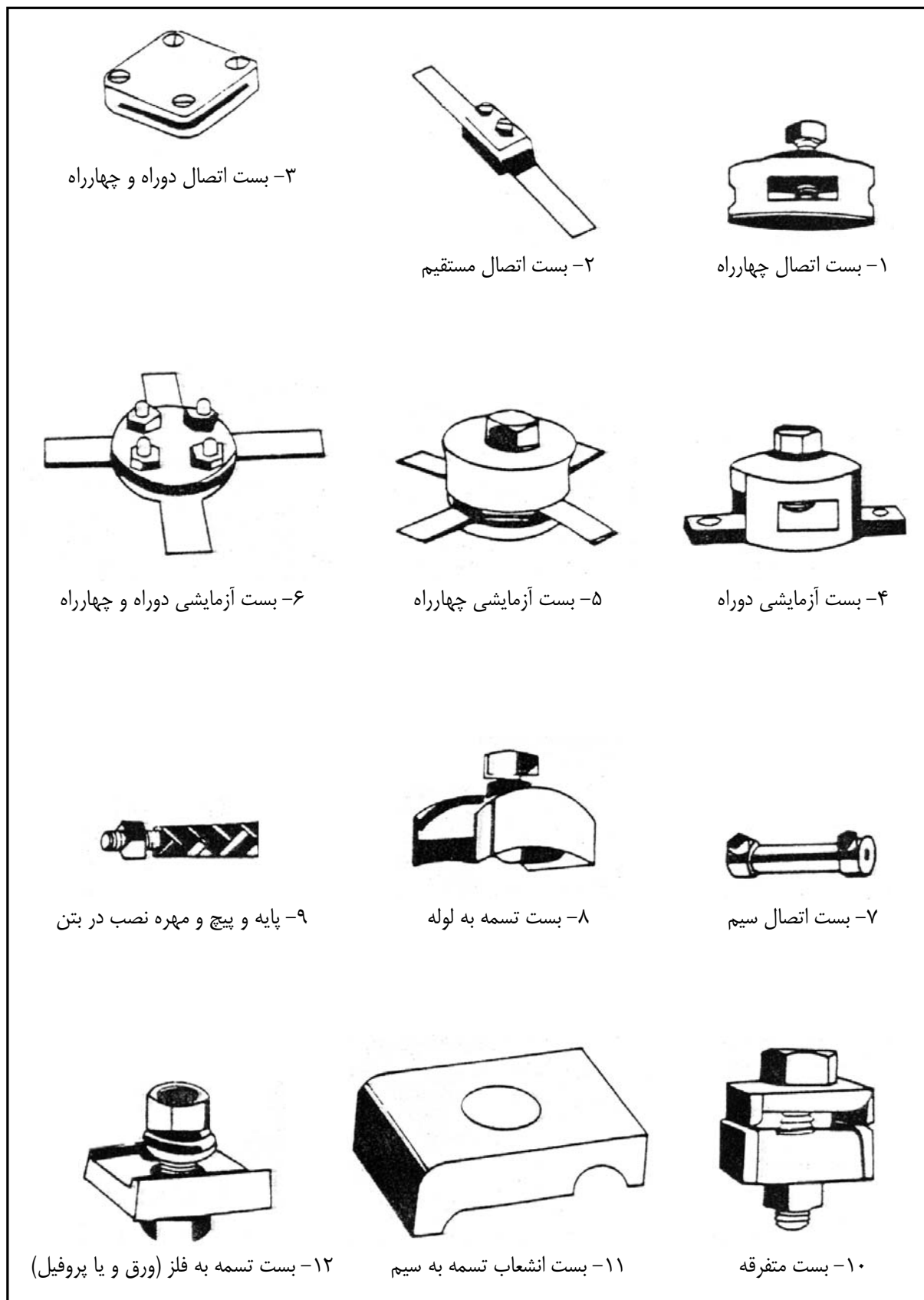
شکل ۱۴-۱۱: اتصالات و وسایل مختلف تسمه کشی
