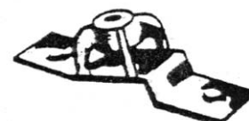
۷- پایه مخصوص نصب روی پشت‌بام‌های شیبدار
