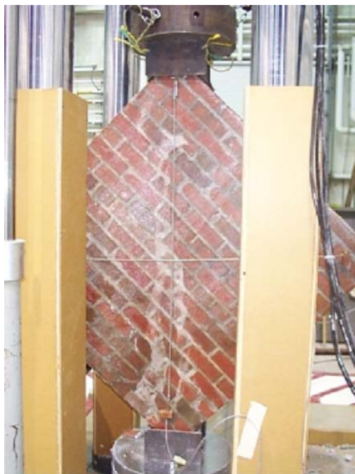
شکل ت-۲-۷- آزمایش فشاری قطری
