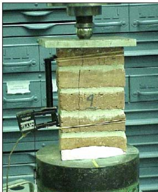
شکل ت-۱-۲ آزمایش تنش فشاری مصالح بر روی نمونه
