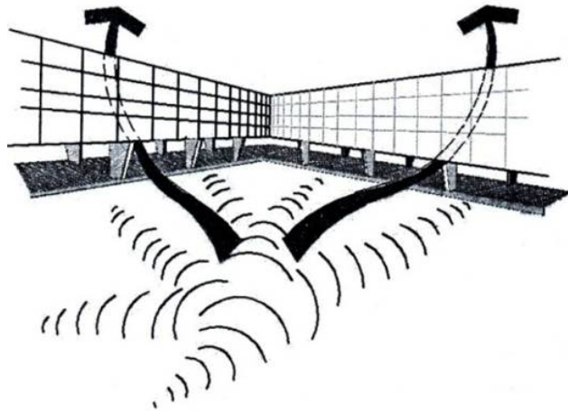
شکل ۲-۲۱-۵- تخلیه موج انفجار از پیلوت باز
